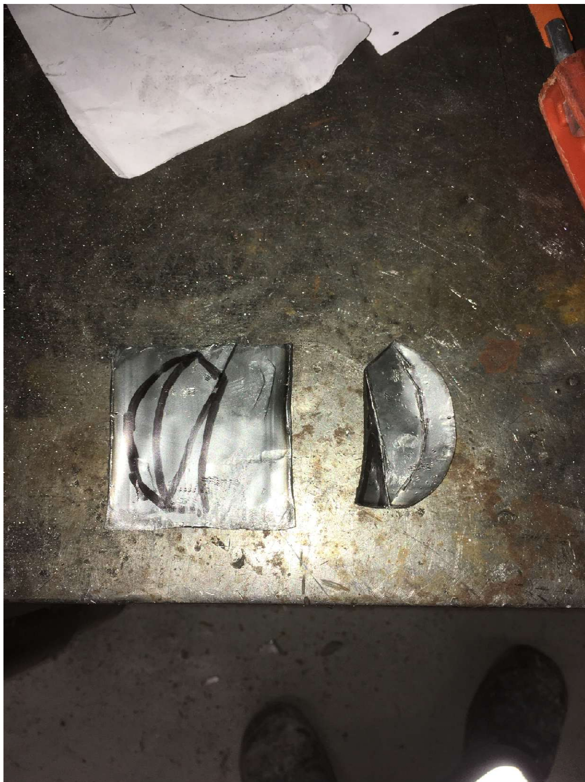
Sepele koostuu vanteesta ja lehdistä. Lehdet on samaa 1,5mm terästä kuin kirjaimenpidike. Lehteen on isketty lehtisuonet taltalla, ja lehdissä on pieni taivutus suonien mukaisesti.
