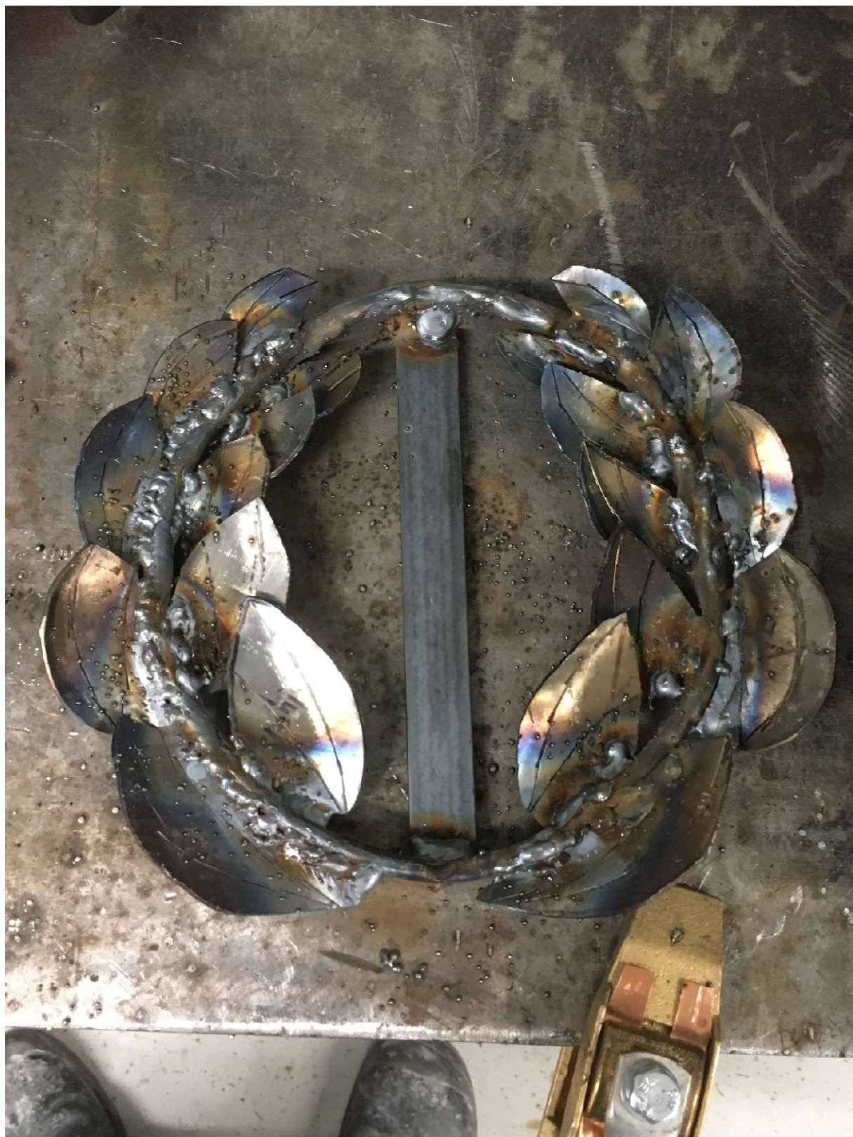
Tässä kuvassa on taivutettu ja hitsattu kaikki lehdet kiinni sekä lisätty lattarauta kiinnitystä varten.
