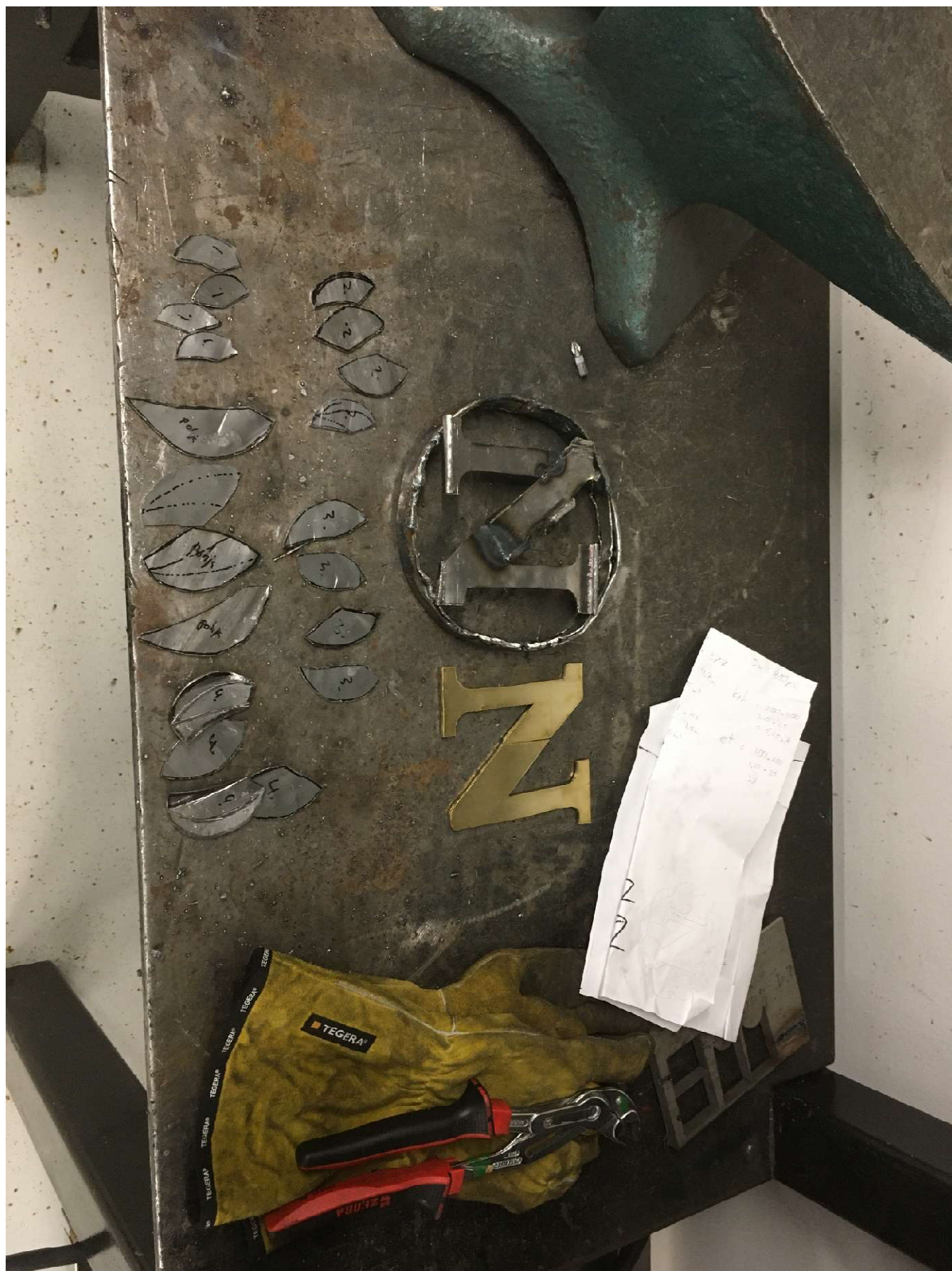
Tässä kuvassa näkyy kaikki lehdet sahattuina, mutta vain osaan on vielä isketty lehtisuonet. Vanne on tehty taivutetusta huonekaluputkesta.
